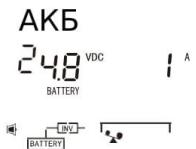
Напряжение АКБ 24,8 В, ток АКБ 1 А.
